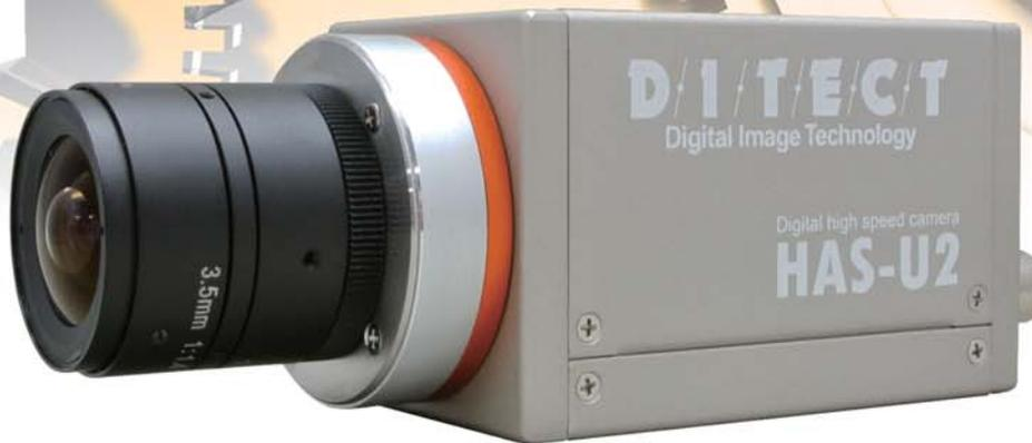
HAS-U2は、有効画素数530万画素 2592×2048ドット、1インチのCMOSセンサーにより、フルフレームで100コマ/秒、VGAで1000コマ/秒、最大7500コマ/秒の高速撮影が可能なデジタルハイスピードカメラです。
